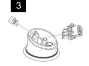
Inserire, premendo in posizione, il boccaglio di ricambio nell'alloggiamento, assicurandosi che la parte anteriore del boccaglio sia a filo con la parte esterna dell'alloggiamento. È necessario un o-ring su tutti i boccagli.
