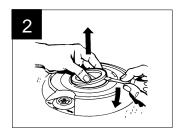
Usare un cacciavite a testa piatta per fare leva sull'alloggiamento del boccaglio e rimuoverlo
