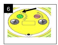
Questa figura illustra la vite di regolazione della rotazione dell'irrigatore dinamico in posizione CERCHIO INTERO.
