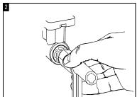
Usando la chiave del selettore valvola, posizionare la chiave contro il dado alla base del solenoide e allinearla con i fori nel dado di base. Tenendo saldamente l'attrezzo, ruotarlo in senso antiorario e rimuovere il tubo del solenoide/il dado di base e il gruppo solenoide.
