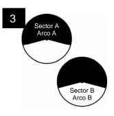
Gli irrigatori della serie 751 e 951 possono funzionare in una delle due configurazioni del getto a settore variabile: arco primario (arco A) e arco secondario (arco B).
