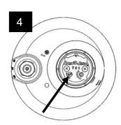
vite di regolazione dell'arco di lavoro sulla sommità dell'alloggiamento per ottenere l'arco di lavoro desiderato. Ruotare la vite in senso antiorario per aumentare l'arco di lavoro oppure in senso orario per ridurlo. Un giro completo della vite di regolazione equivale a circa 20 gradi dell'arco di lavoro.
