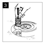
Rimuovere la cartuccia del selettore dal corpo dell'irrigatore. Prima di sostituire la cartuccia del selettore, assicurarsi che la guarnizione del selettore sia piatta e sia posizionata al fondo dell'alloggiamento del selettore.
