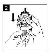
Inserire la valvola sull'attrezzo di inserimento per valvole. Allineare l'orifizio del flusso pilota sulla valvola con la grande scanalatura arrotondata sull'attrezzo per valvole.
