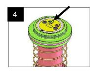
Per gli irrigatori della serie 751 e 951, la selezione della configurazione CERCHIO INTERO/SETTORE VARIABILE viene effettuata ruotando la freccia della vite di regolazione sul SEMICERCHIO (funzionamento a settore variabile) o sul CERCHIO INTERO (funzionamento a cerchio intero).
