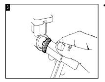
Prima di reinstallare il nuovo gruppo solenoide, assicurarsi che l'o-ring sia posizionato correttamente. Posizionare il tubo del solenoide/il dado di base e il gruppo solenoide contro l'alloggiamento del selettore e serrare a mano. Chiudere bene il dado di base con la chiave del selettore valvola.
