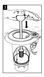
Inserire l'attrezzo per valvole nel corpo dell'irrigatore dinamico, allineando le due nervature all'interno del corpo dell'irrigatore con le fessure sul lato dell'attrezzo. Premere l'impugnatura verso il basso fino a che la testa dell'attrezzo non raggiunge il fondo del corpo dell'irrigatore. Quindi premere con decisione verso il basso per posizionare la valvola e i seeger. Rimuovere l'attrezzo per valvole e verificare che entrambi i seeger siano posizionati correttamente.
