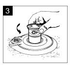
Per ottenere i risultati migliori, girare la torretta dell'irrigatore per individuare il fermo (il fermo corsa è il punto in cui l'irrigatore si arresta e inizia a ruotare in direzione opposta). Per far avanzare manualmente l'alloggiamento del boccaglio, spostarlo LENTAMENTE nella stessa direzione in cui si sta muovendo. Dopo aver individuato il punto di fermo corsa, riportare l'irrigatore al punto di fermo corsa di sinistra.
