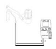
Il WP1-AG è provvisto di una connessione per un sensore del tipo attivo (cavo giallo).
