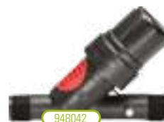
Filtri RBY con regolatore di pressione - Disponibile con attacco 3/4" M e 1" M con riduzione della pressione a 2 o 2,8 bar - Massima pressione di esercizio 10 bar - Filtraggio 150 Mesh
