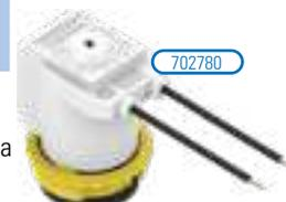
SOLENOIDI A 9/12V - BISTABILE (Latching Solenoid) - Fornendo un impulso positivo la valvola si apre; fornendo un impulso negativo la valvola si chiude - Si definisce "freddo": non dissipa energia. - Potenza 3,7 W - Assorbimento 400 mA
