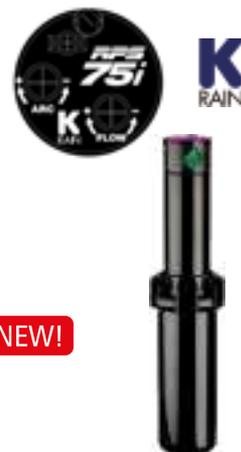
**RPS 75i con INTELLIGENT FLOW TECHNOLOGY - Questo esclusivo dispositivo, brevetto KRAIN, permette di regolare simultaneamente il raggio e la portata idrica. La vite rompigitto, usata in tutti gli altri irrigatori, riduce il raggio ma la portata rimane la stessa con problemi di uniformità idrica.**
